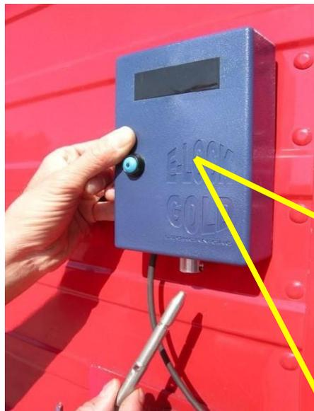
E Lock GOLD è un dispositivo di sicurezza UNICO sul mercato perché AUTOALIMENTATO: possiede una batteria interna che si può sostituire quando scarica.
