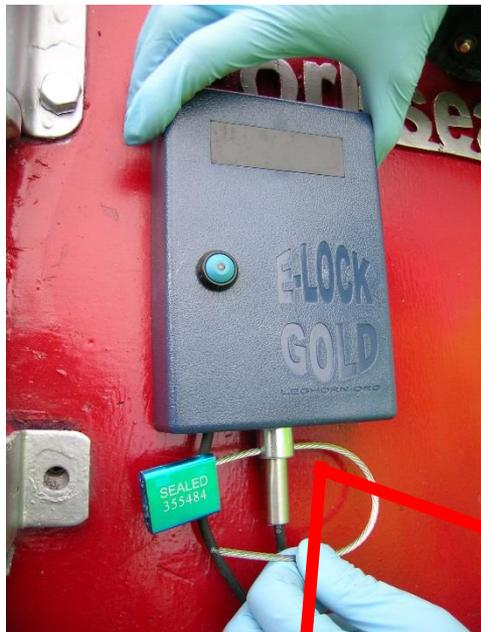
L' E LOCK GOLD può essere ancorato in maniera fissa, cioè avvitando un supporto metallico alla porta del camion o del container ( in questo caso può essere implementato con un sensore di distacco che avvisa se viene rimosso) con piastra magnetica, indicata per gli usi su veicoli diversi a rotazione.
