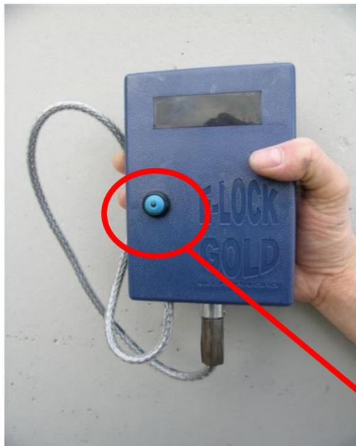
Il bottone presente sul case dell' E LOCK GOLD serve per entrare in programmazione fare il **check** di funzionalità su sigilli che restano per un certo tempo inutilizzati avere un feedback visivo sulla funzionalità del sigillo grazie ai significati di vari modi di lampeggiare del led inserito nel bottone a spinotto chiuso, premendo il bottone il sigillo invia messaggio con suo identificativo.
